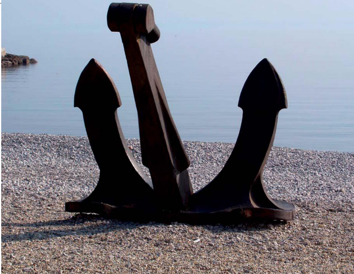
Slika 7. Brodska sidra, uz ribarske mreže, najveći su neprijatelji podvodnih kabela.
